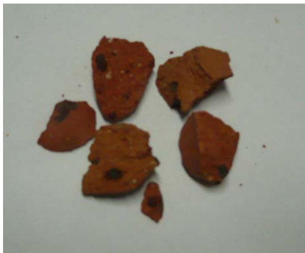
รูปที่ 1.2 ชิ้นส่วนของจุดดำและคราบดำของผลิตภัณฑ์
