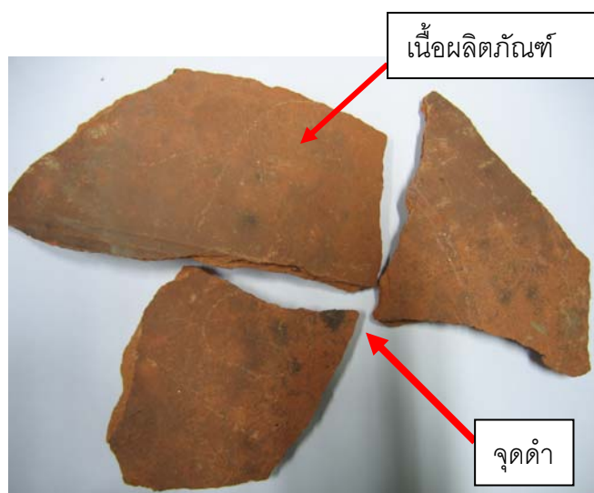
รูปที่ 2 ชิ้นงานที่ใช้วิเคราะห์องค์ประกอบทางเคมีโดยเทคนิค EDS ของเนื้อผลิตภัณฑ์และจุดดำ
