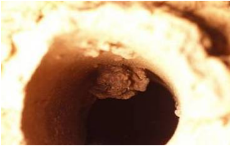
เศษตะกรันจากการถลุง โลหะ ที่ติดอยู่ด้านในท่อ ลม
