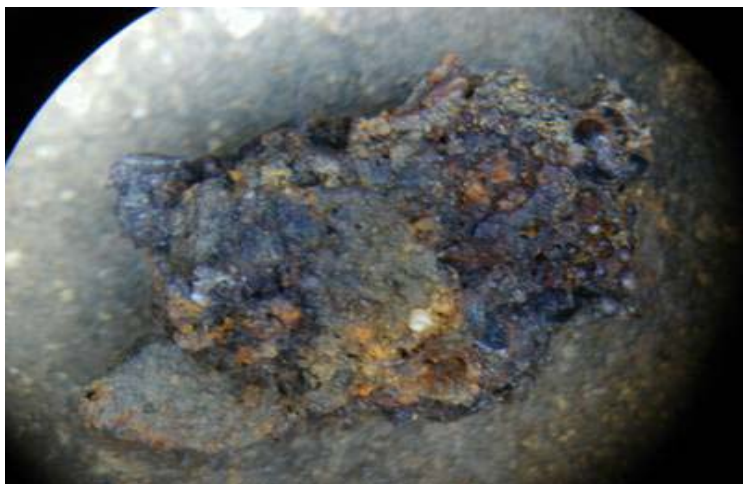
เศษตะกรันจากการถลุง โลหะ เส้นผ่านศูนย์กลาง ประมาณ 1 เซนติเมตร เนื้อมึนพรุนปริมาณมาก ภายใต้กล้องจุลทรรศน์ กำลังขยาย 1x
