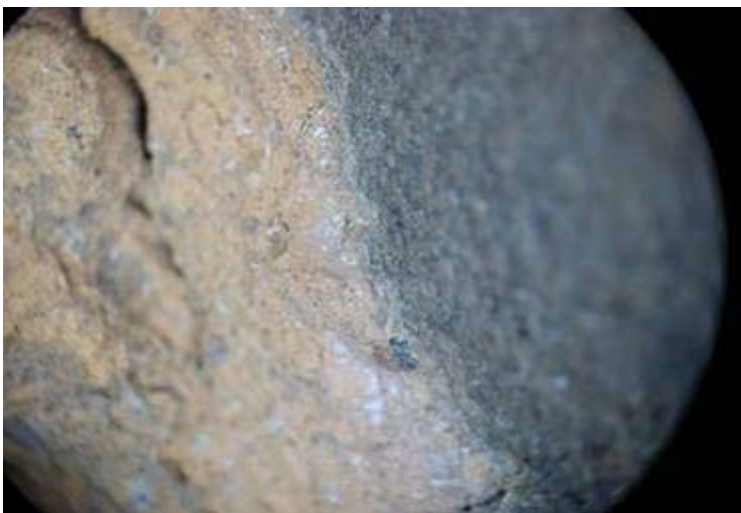
ลักษณะเนื้อบริเวณขอบ ปากด้านในท่อลม มี ลักษณะจับตัวแข็งผิว เรียบ ภายใต้กล้อง จุลทรรศน์กำลังขยาย 1x
