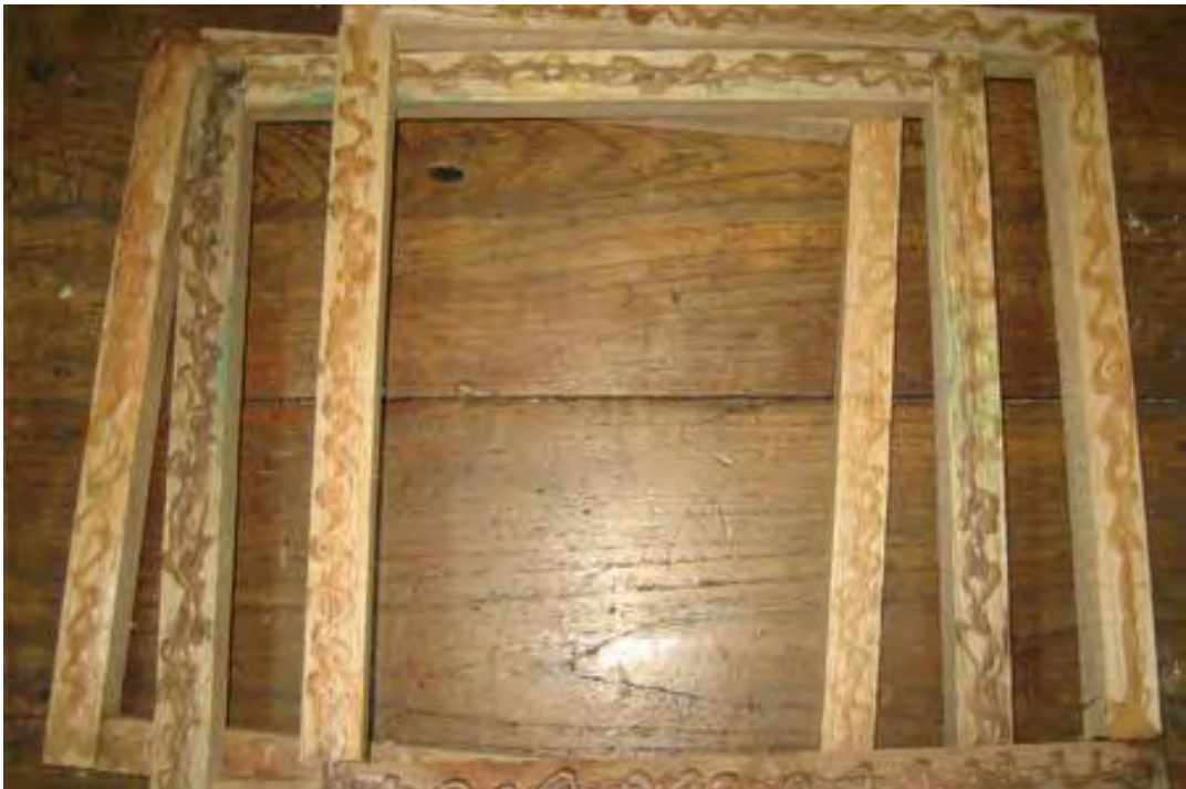
เป็นกรอบไม้สี่เหลี่ยมมีหลายลักษณะ ใช้สำหรับขึงผ้าในเวลาเขียนผ้าในเวลาเขียนเทียน
