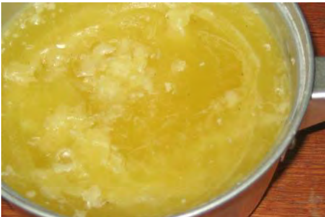
เทียนที่ใช้เขียนผ้า ถ้ามีส่วนผสมของขี้ผึ้งมาก เทียนจะเหนียว ถ้าผสมพาราฟินมาก เทียนจะเปราะ
