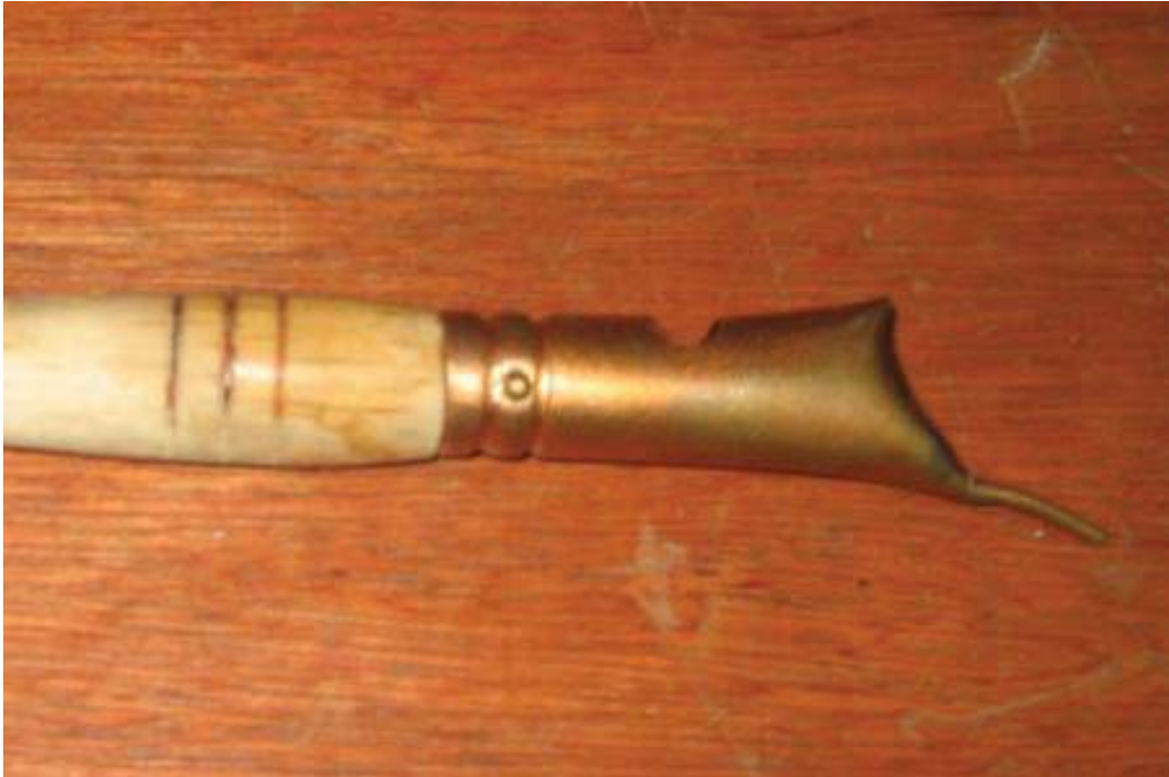
เป็นเครื่องมือสำหรับใช้เขียนลวดลายเขียนลงบนผ้า มีขนาดแตกต่างกันทั้งเส้นเล็ก เส้นกลาง และเส้นใหญ่หรืออาจใช้แปรงทาเล็กเกอร์แบ่งเป็นซีก ๆ จุ่มเทียนเขียนลายบนผ้าก็ได้
