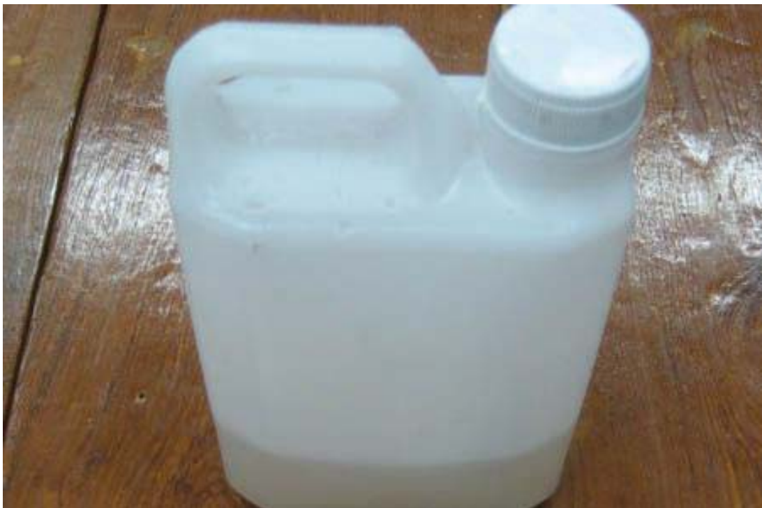
ซิลิเกรตใช้สำหรับทาบนผ้า เพื่อให้สีติดทนนาน ซึ่งควรผสมกับน้ำเพื่อให้ไม่หนืดเกินไป อัตราส่วนที่ใช้ คือ โซเดียมซิลิเกต 1 ส่วน ต่อน้ำ 2 ส่วน แต่มีเทคนิคการผสมสำหรับผ้าต่างชนิดกัน โดยผ้าหนาจะผสมให้เหลวเพื่อให้ซึมผ่านลงไปได้ ผ้าบางจะผสมให้ข้นเพื่อป้องกันไม่ให้ไหลทะลุจนเปราะอะ เช่น ผ้าฟูลีซึ่งเป็นผ้าไหมเนื้อบางจะผสมให้ข้น ผ้าฝ้ายเนื้อหนาก็จะผสมให้เหลว
