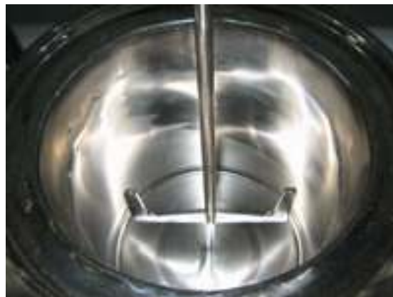
รูป ก2 ถังสแตนเลส 2 ชั้น สำหรับตกผลึกความจุ 6.5 ลิตร และใบกวนสแตนเลสรูปตัวยู (เส้นผ่านศูนย์กลางใบพัด 15 เซนติเมตร ยาว 15 เซนติเมตร และสูง 30.5 เซนติเมตร)
