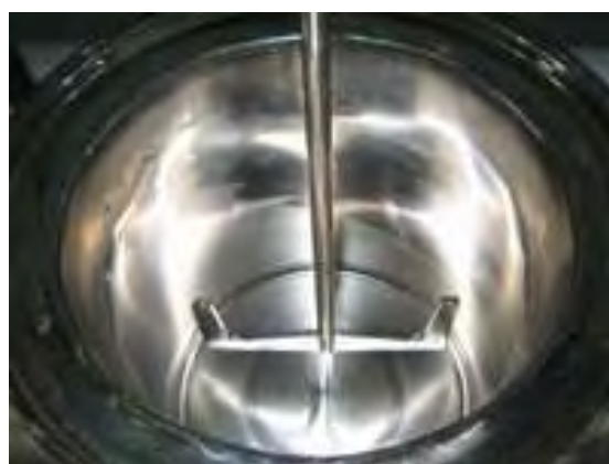
รูป ก2 ถังสแตนเลส 2 ชั้น สำหรับตกผลึกความจุ 6.5 ลิตร และใบกวนสแตนเลสรูปตัวยู (เส้นผ่านศูนย์กลางใบพัด 15 เซนติเมตร ยาว 15 เซนติเมตร และสูง 30.5 เซนติเมตร)
