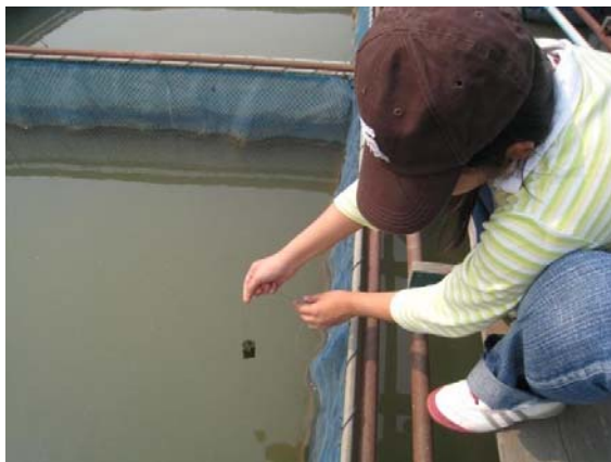
ภาพที่ 44 การติดตั้งเครื่องบันทึกอุณหภูมิ (Data logger) ในน้ำและอากาศบริเวณที่แขวนกระชังเลี้ยงปลาทดลอง
