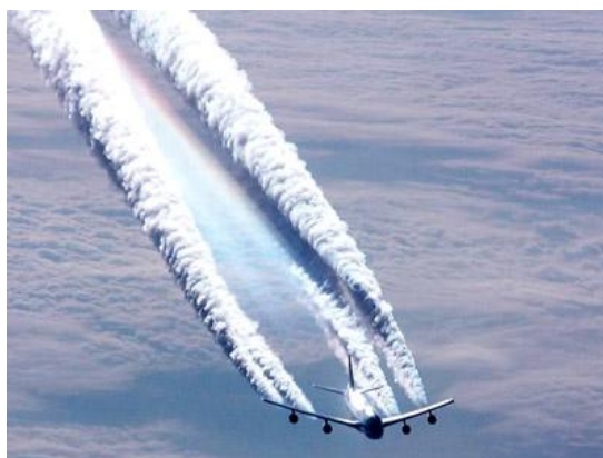
ภาพ 12 Contrail ที่เกิดจากเครื่องบินที่บินอยู่ในระดับสูง
