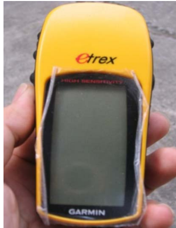
รูปที่ 4-7 เครื่องมือ GPS ในการเก็บพิกัดที่ตั้งของแหล่งน้ำ
