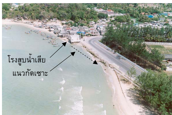
ภาพที่ 7 การกัดเซาะที่หาดชลาทัศน์ เนื่องจากโรงสูบน้ำเสียที่เป็นสิ่งแปลกปลอมที่ล่วงล้ำขอบเขตที่ได้รับอิทธิพลจากชายฝั่งของหาดชลาทัศน์
