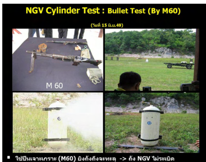
ภาพที่ 2-8 แสดงการทดสอบการยิง
