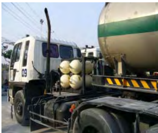
ภาพที่ 2-14 แสดงตัวอย่างการติดตั้งถังแก๊สเอ็นจีวี
