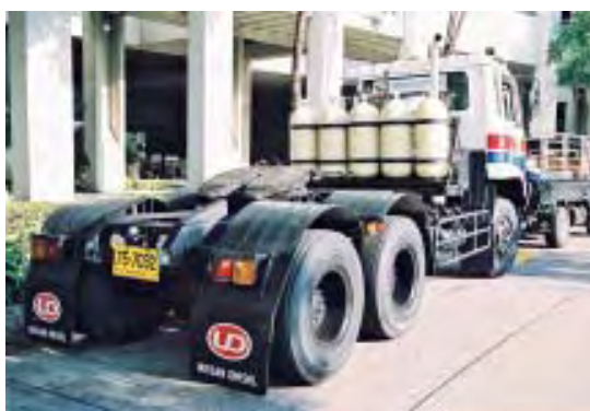
ภาพที่ 2-10 แสดงรถบรรทุกและรถหัวลากที่ติดตั้งอุปกรณ์ CNG ระบบ DDF แบบดูดแก๊ส
