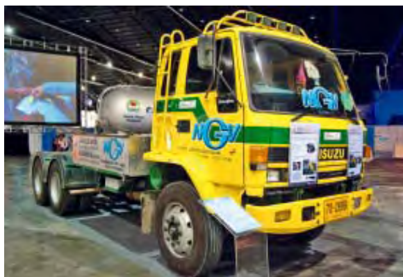
ภาพที่ 2-13 แสดงรถหัวลากเปลี่ยนเครื่องยนต์ดีเซลเดิมเป็นเครื่องยนต์ CNG (Re-powering)
