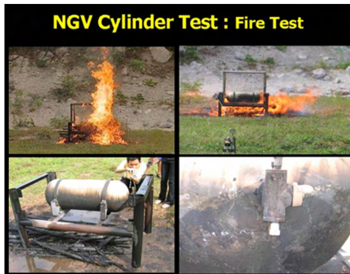
ภาพที่ 2-7 แสดงการทดสอบการไหม้ไฟ
