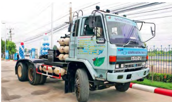
ภาพที่ 2-11 แสดงรถบรรทุกและรถหัวลากที่ติดตั้งอุปกรณ์ NGV ระบบ DDF แบบฉีดก๊าซ
