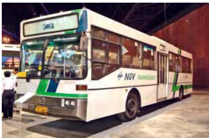
ภาพที่ 2-12 แสดงรถโดยสารเครื่องยนต์ดีเซลดัดแปลงมาใช้ CNG เพียงอย่างเดียวแบบฉีดก๊าซ
