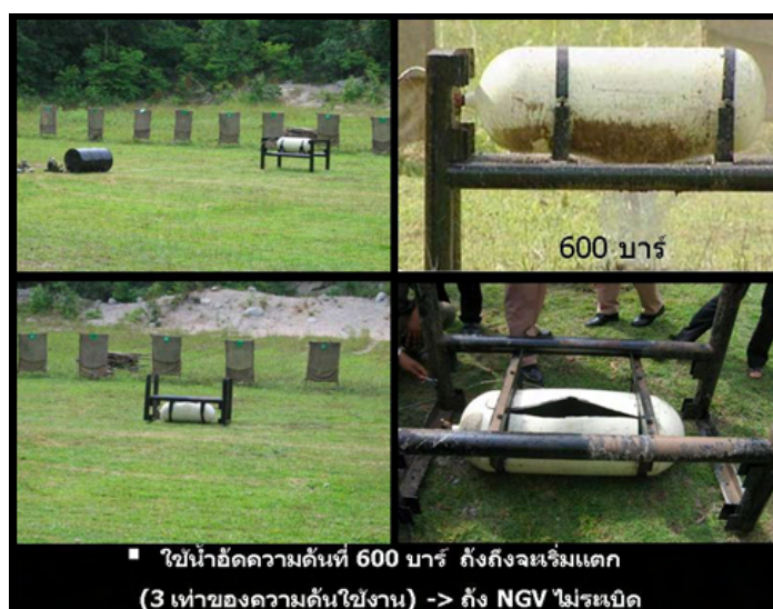
ภาพที่ 2-6 แสดงการทดสอบความดัน
