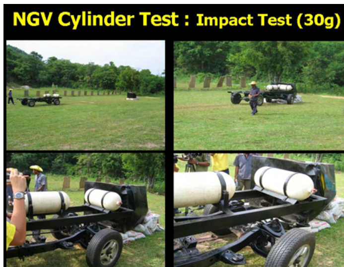
ภาพที่ 2-9 แสดงการทดสอบการชน
