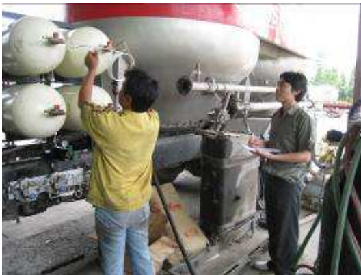
รูปที่ 3 แสดงการเก็บข้อมูลด้านพลังงาน และอุปกรณ์ NGV แบบ Dedicated
