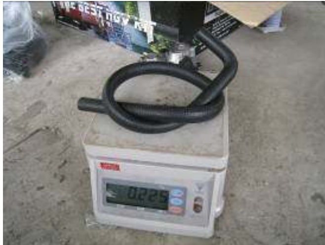
รูป 4.1 แสดงการชั่งน้ำหนักเพื่อหาส่วนประกอบของวัตถุดิบอุปกรณ์ NGV
