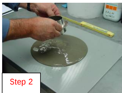
รูปที่ 3.1 วิธีการทดสอบ Mini slump
