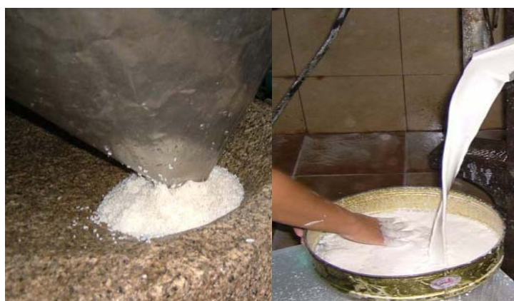
รูปที่ 2-2 แสดงการโม่ข้าวและบดข้าวหักให้เป็นน้ำแป้งผ่านเครื่องบด
