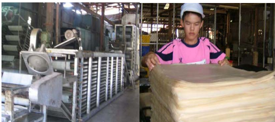
รูปที่ 2-4 แสดงทำแห้งโดยผ่านแผ่นกล้วยเดี่ยวสดในตู้อบลมร้อนและการผึ่งลม
