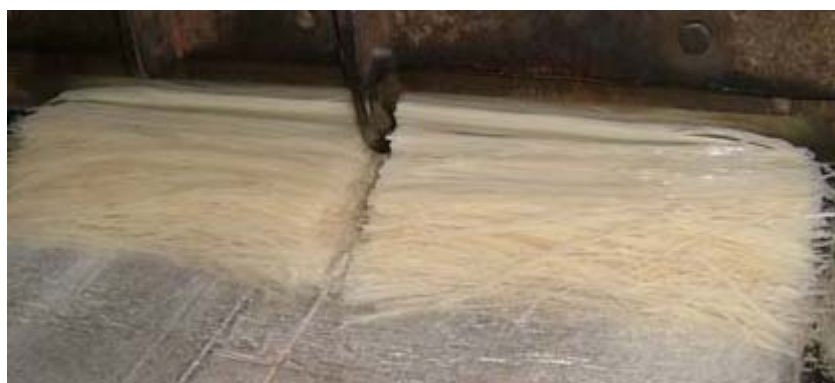
รูปที่ 2-5 แสดงการตัดแผ่นกล้วยเดี่ยวเป็นเส้นด้วยเครื่องตัด
