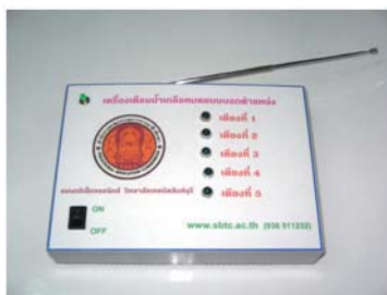
รูปที่ 4 ภาควรับ เครื่องเตือนน้ำเกลือหมดแบบบอกตำแหน่ง
