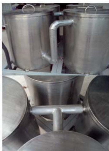
รูปที่ 5 ท่อนำก๊าซร้อนให้ไหลผ่านถังผลิต
