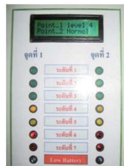
รูปที่ 12 การแสดงผลระดับน้ำที่จอแสดงผล LCD และ LED
