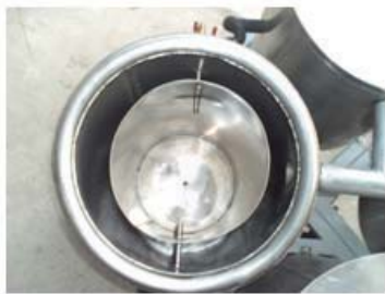
รูปที่ 3 ลักษณะภายในของถังผลิตไบโอดีเซล พลังงานความร้อนร่วม
