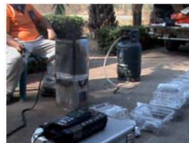
รูปที่ 3 แสดงวิธีการวัดแก๊สที่เกิดจากการเผาไหม้เชื้อเพลิงแท่ง
