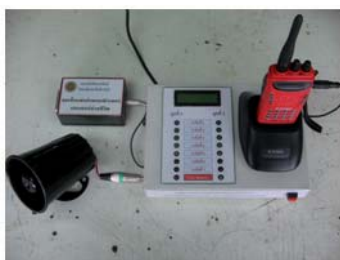
รูปที่ 10 การทดลองภาครับเครื่องเตือนภัยน้ำป่าไร้อายุจริยะ
