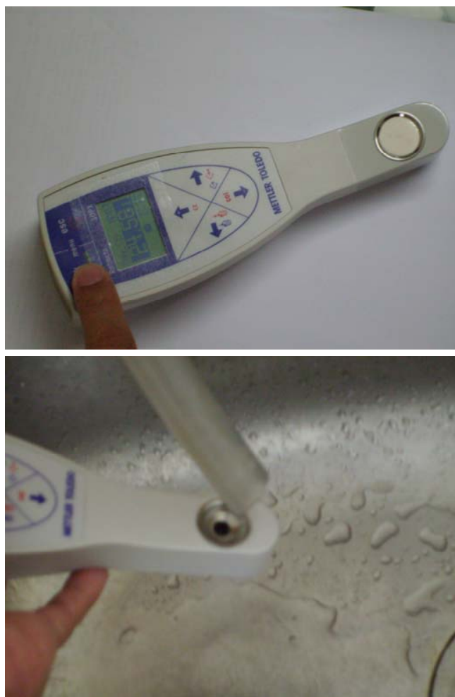
รูปที่ 2.6 แสดงขั้นตอนการใช้งานเครื่องวัดค่าดัชนีการหักเหแสง
