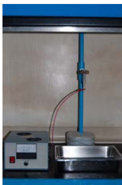
รูปที่ 5 การปั่นด้วยไฟฟ้าสถิตลงบนอุปกรณ์รองรับภาตสแตนเลสบรรจุกรดอะซิติกเข้มข้น
