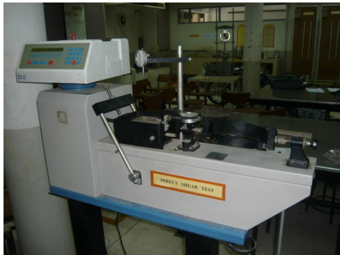
รูปที่ 3 แสดงวิธีการทำการทดสอบแรงเฉือนโดยตรง
