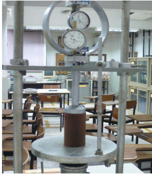
รูปที่ 1 แสดงการทดสอบ Unconfined Compression Test
