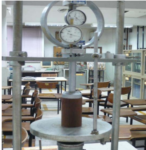
รูปที่ 1 แสดงการทดสอบ Unconfined Compression Test
