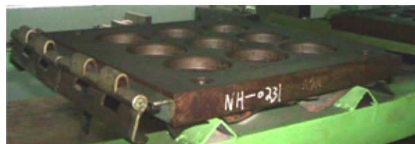
ภาพที่ 11 แม่พิมพ์สำหรับสายรัดข้อมือ แบบเบ้าเดียว (ซ้าย) และแบบหลายเบ้า (ขวา)
