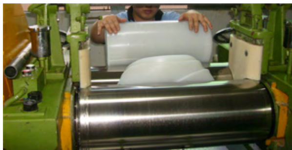
ภาพที่ 10 การบดยางให้นิ่มและการผสมสี
