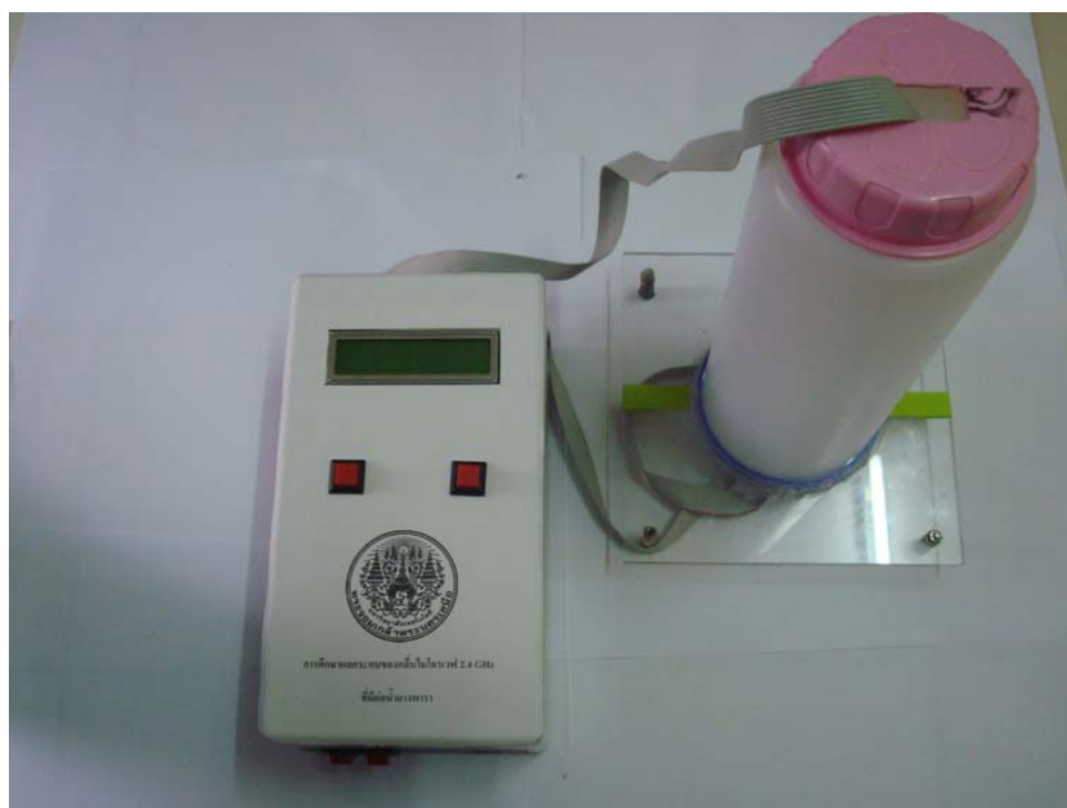
รูปที่ 10 เครื่องต้นแบบเครื่องวัดความเข้มข้นของน้ำยางพาราโดยใช้คลื่นไมโครเวฟ
