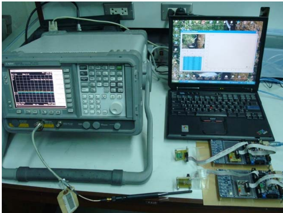
รูปที่ 3 การต่อทดสอบความแม่นยำของมอดูล ST-TR2500 กับเครื่อง Spectrum analyzer
