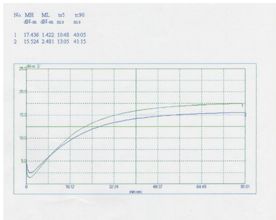
รูปที่ 4 กราฟระหว่างแรงบิดกับเวลาจากเครื่อง ODR
