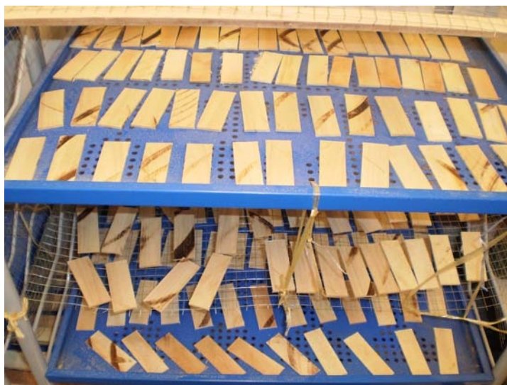
รูปที่ 2 การเตรียมชิ้นไม้แบบ Two-ply tensile shear specimen
