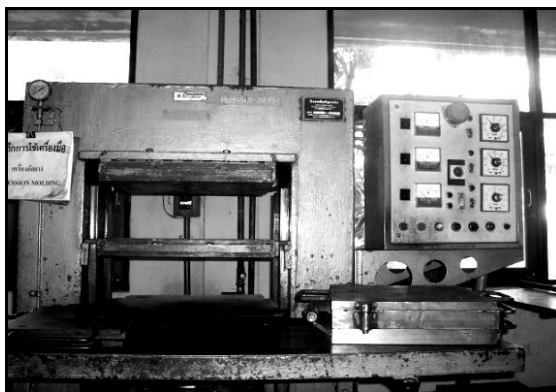
รูปที่ 2.12 เครื่องอัดเป่า (Compression molding)
