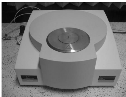
รูปที่ 2.14 เครื่องวิเคราะห์เชิงความร้อน (Thermal gravimetric analyzer)
