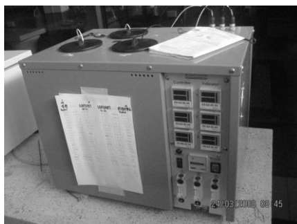
รูปที่ 2.15 ตู้อบบ่มเร่งด้วยอากาศร้อนแบบช่อง (Cell typed ageing oven)
