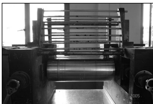
รูปที่ 2.11 เครื่องผสมยางสองลูกกลิ้ง (Two roll mill)
