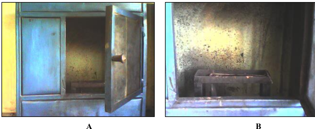
รูปที่ 2.16 เครื่องทดสอบการเผาไหม้ (A) ห้องทดสอบ และ (B) ส่วนที่เป็นตะเกียงและตะแกรง
