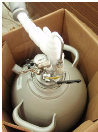
ภาพที่ 2-2 แสดงชุดอุปกรณ์ใช้ในการสร้างสถานะอุณหภูมิต่ำโดยใช้ไอของก๊าซไนโตรเจน
