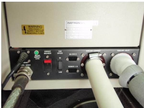
ภาพที่ 2-2 แสดงชุดอุปกรณ์ใช้ในการสร้างสถานะอุณหภูมิต่ำโดยใช้ไอของก๊าซไนโตรเจน
