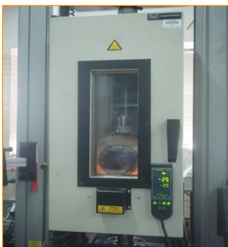
ภาพที่ 2-4 แสดงการทดสอบที่อุณหภูมิติดลบ 25 องศาเซลเซียส
