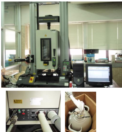
ภาพที่ 1 เครื่องทดสอบแรงดึง Intron Universal Testing Machine และชุดอุปกรณ์ใช้ในการสร้างสภาวะอุณหภูมิต่ำโดยใช้ไอของก๊าซไนโตรเจน
