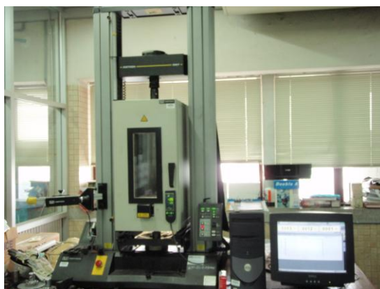
ภาพที่ 2-1 แสดงเครื่องทดสอบและห้องควบคุมอุณหภูมิ
