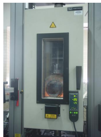
ภาพที่ 2 แสดงการทดสอบการกดตัวอย่างคันที่อุณหภูมิติดลบ 25 องศาเซลเซียส
