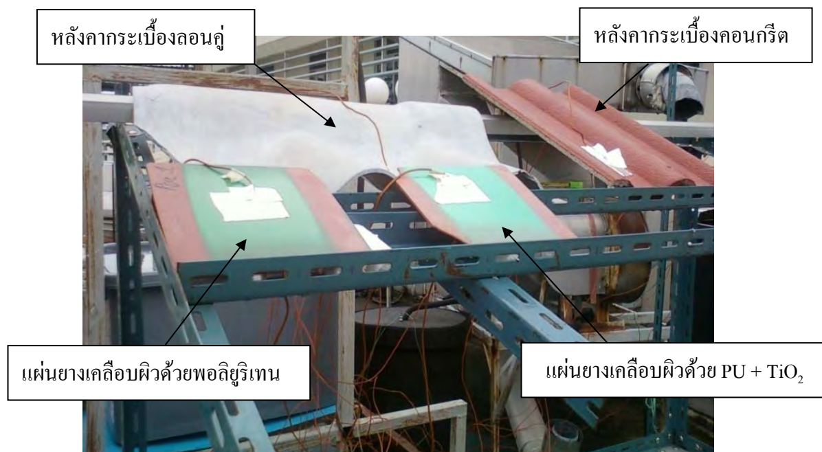
รูปที่ 4.12 การติดตั้งชิ้นงานทดสอบที่สภาวะการใช้งานจริง
