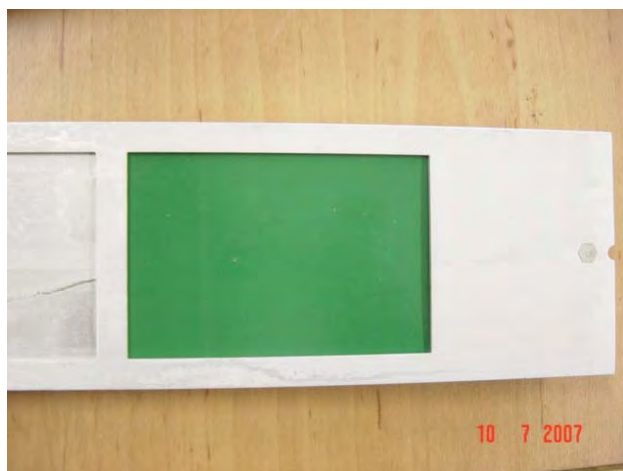
รูปที่ 3.10 ชิ้นงานที่เคลือบผิวพอลิยูรีเทนสำหรับทดสอบการเร่งสภาวะด้วยรังสี UV
