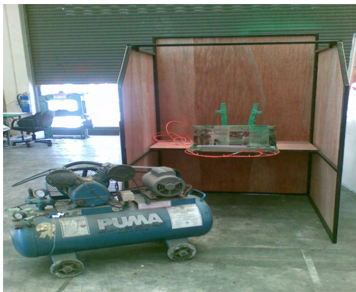
รูปที่ 3.4 ห้องพ่นเคลือบที่ติดตั้งแผงกั้นลม
