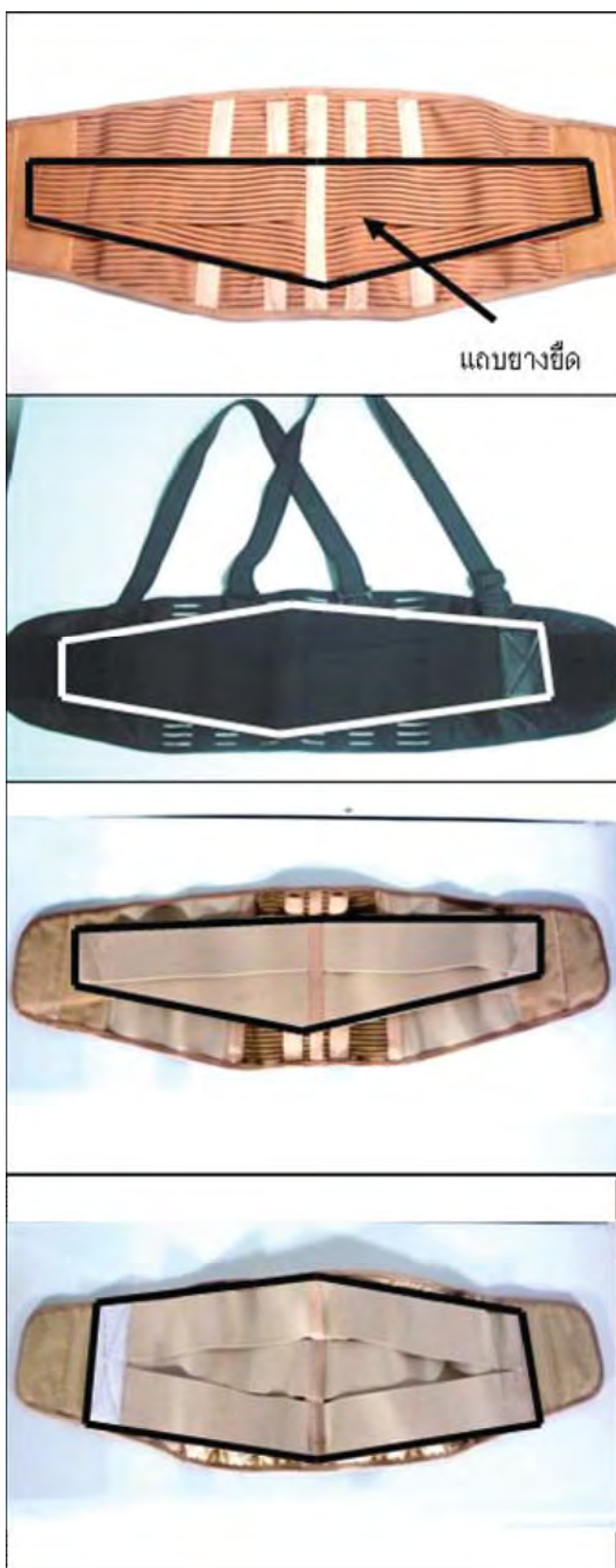
รูปที่ 3.11 แสดงเข็มขัดพยุงหลังทั้ง 4 แบบที่ใช้ทดสอบหาค่าความแข็งตัวของแถบยางยืด
