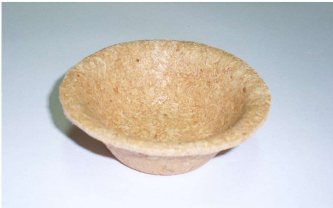
ภาพที่ 41 ตัวอย่างจีลีสือขึ้นรูปที่มีกาวเป่งมันสำหรับ กาวพอลิไวนิลแอลกอฮอล์และน้ำยางพารา
