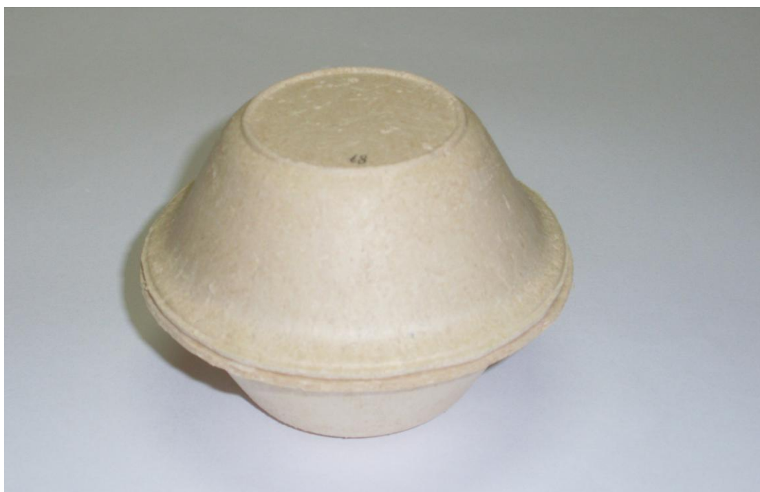
ภาพที่ 43 ตัวอย่างโฟมแป่งผสมน้ำยางพาราที่มีขี้เลื่อยเป็นสารเสริมแรงซึ่งใช้ทดสอบความแข็งแรงต่อการตกกระแทก (G value)
