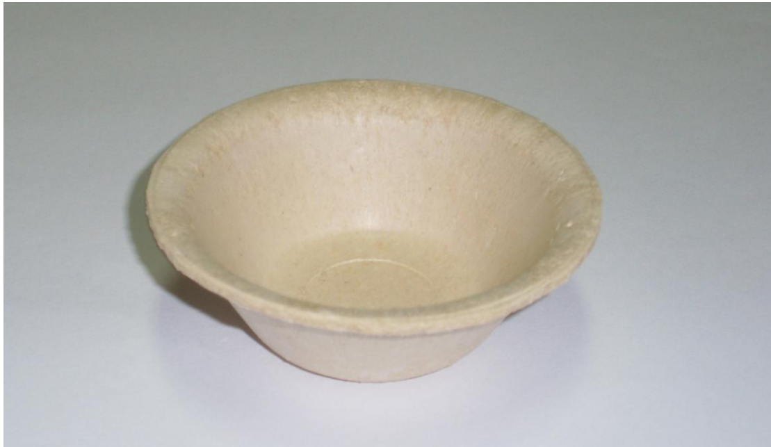
ภาพที่ 40 ตัวอย่างโฟมเป่งมันสำหรับหลังผสมน้ำยางพาราที่มีจีลีสือเป็นสารเสริมแรง
