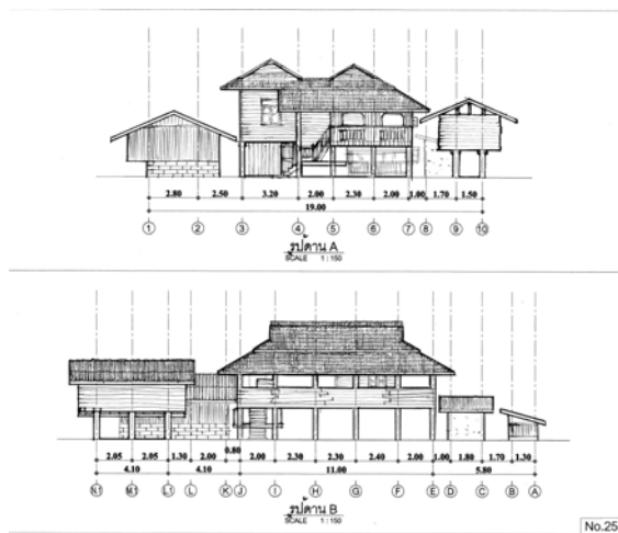
ภาพที่ 4.175 แสดงรูปด้าน A รูปด้าน B หลังที่ 25 ชุมชนบ้านไร่ ที่มา : จากการสำรวจ ปี พ.ศ. 2552
