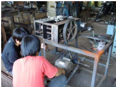
รูปที่ 4 การสร้างเครื่องจกตอกไม้ไฟ
