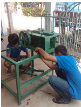
รูปที่ 5 ประกอบตัวเครื่องจกตอกไม้ไฟ
