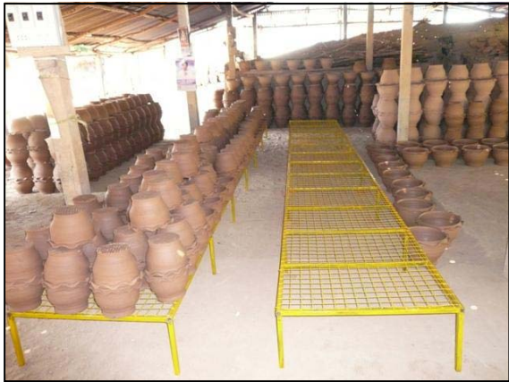
รูปที่ 7 ตะแกรงยกพื้นเพื่อไล่ความชื้นในบริเวณกันกระถาง
