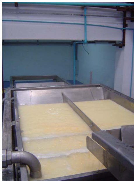
รูปที่ ค-7 การล้างเมล็ดข้าวโพดด้วยเครื่องล้างเมล็ด (Floatation Cleaner)
