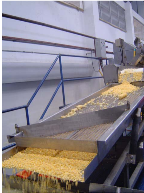
รูปที่ ค-6 การร่อนข้าวโพดด้วยตะแกรงหยาบ
