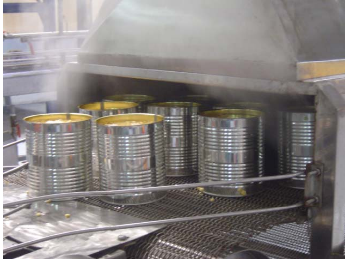
รูปที่ ค-13 การไล่อากาศในกระป๋องข้าวโพดโดยเครื่องไล่อากาศ
