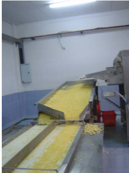
รูปที่ ค-8 การร่อนคัดขนาดเมล็ดข้าวโพดด้วยตะแกรงร่อนละเอียด
