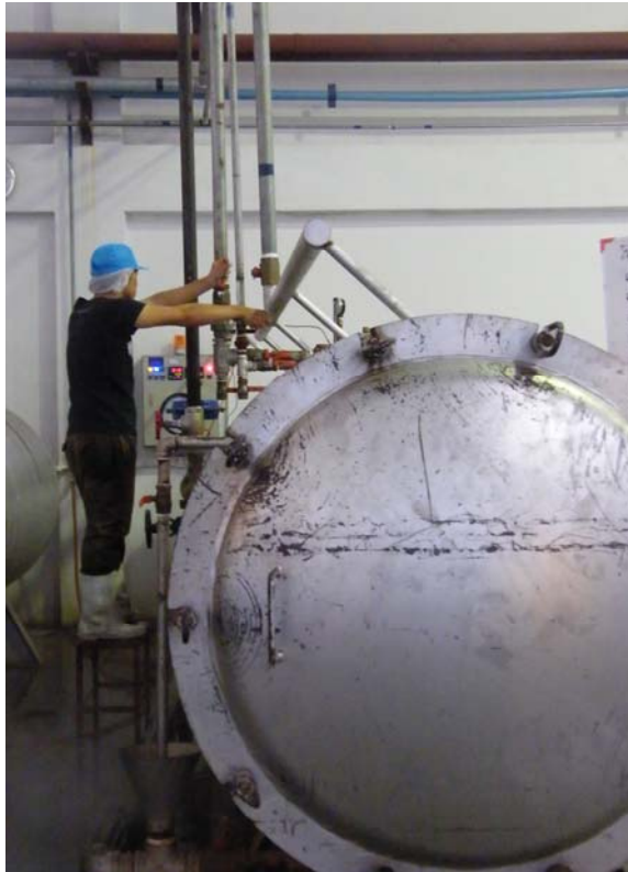
รูปที่ ค-15 การฆ่าเชื้อด้วยหม้อนึ่งฆ่าเชื้อ (Retort)
