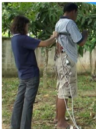
ภาพที่ 25 แสดงการติดเครื่องวัด EMG และ Accelerometer
