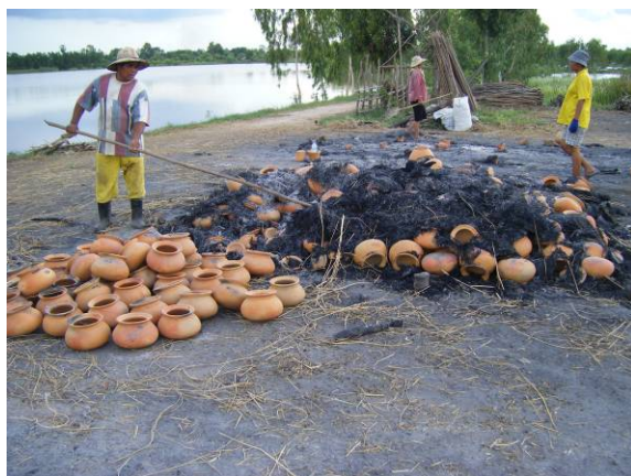
ภาพแสดงผลิตภัณฑ์ที่ได้มาเตรียมเผา ในลักษณะการเผาที่เรียกว่า “การเผาแบบเปิด หรือกลางแจ้ง”
