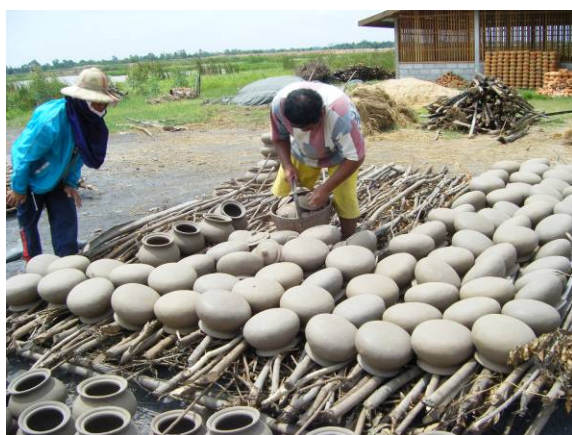
ภาพแสดงการนำหม้อมาตากแดดให้แห้งก่อนนำไปเผา
