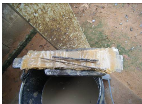
ภาพแสดง วัสดุ อุปกรณ์ในการปั้นหม้อ คือ พลาสติกสำหรับสรีปากหม้อ ไม้วัดขนาด และเส้นเอ็น
