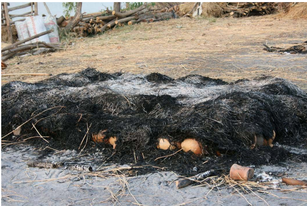
การเผาโดยใช้ฟางและฟืนเป็นเชื้อเพลิงต้องใช้เชื้อเพลิงมาก
