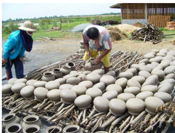
ภาพแสดงการนำหม้อมาตากแดดให้แห้งก่อนนำไปเผา
