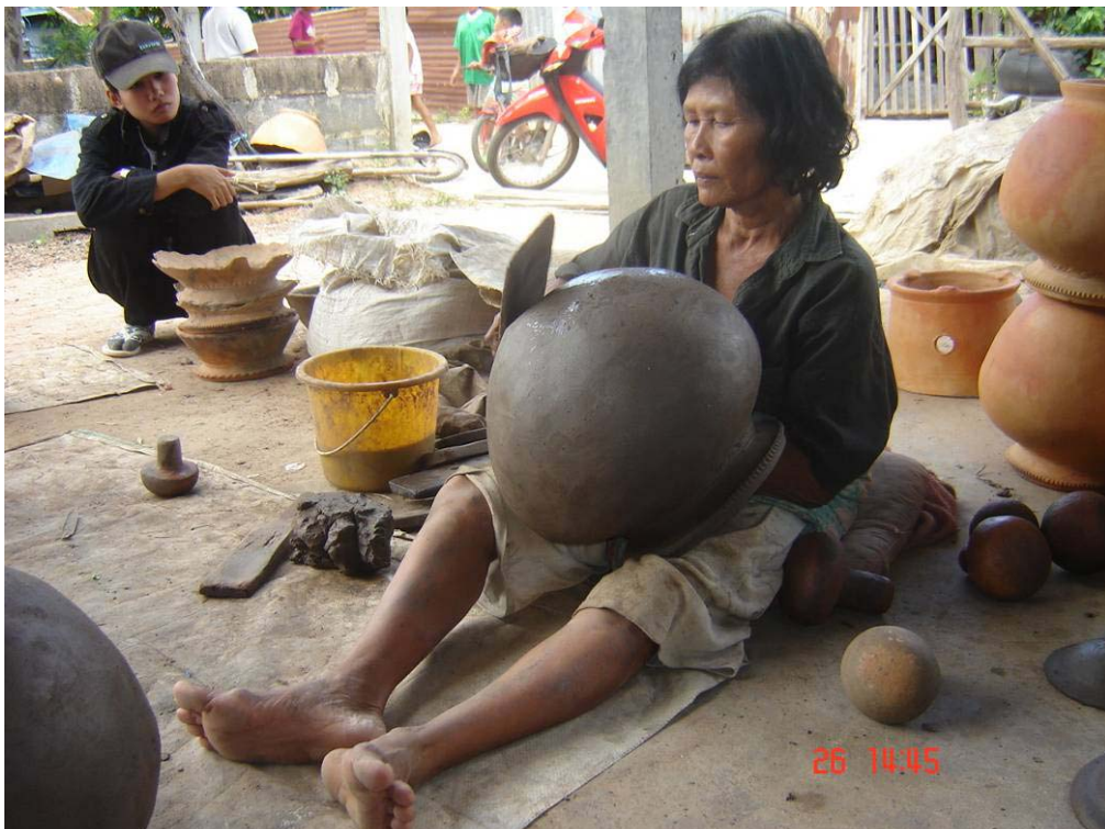
การตีกันหม้อด้วยการใช้หินดูและไม้ตีแบบโบราณ
