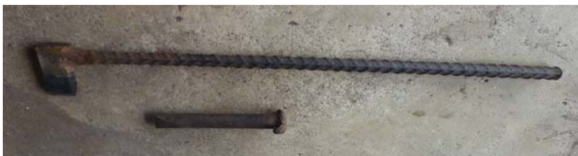
สกัด ด้านล่างคือสกัดอันเล็กสำหรับงานตกแต่ง ด้านบนคือสกัดอันใหญ่สำหรับงานตัดขึ้นรูป
