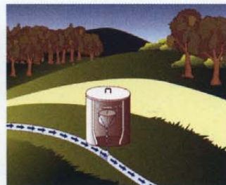
ลิ้นระบายอากาศ
