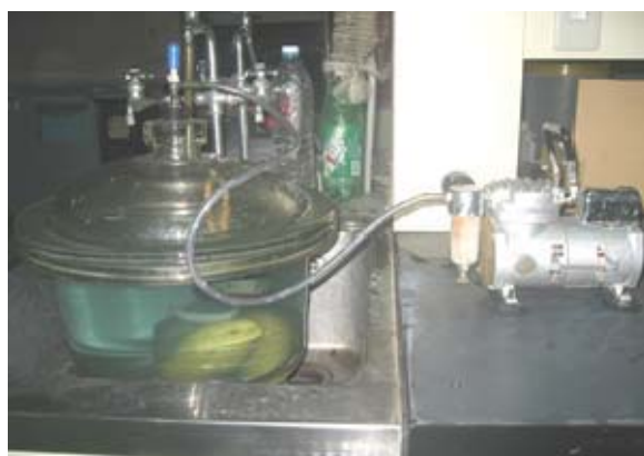
รูปที่ 3.8.3 อุปกรณ์ที่ใช้ในการหาแก๊สที่สะสมอยู่ภายในผลมะม่วง ลูกศรีษะขาวแสดงฟองแก๊สจากผล
