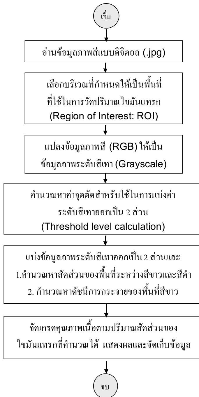
รูปที่ 3.7 ฟังงานแสดงโครงสร้างระเบียบวิธีการคำนวณที่ใช้ทดสอบบน MATLAB และนำไปใช้ในซอฟต์แวร์ประมวลผลภาพที่สร้างขึ้น (Meat Marbling 1.0)
