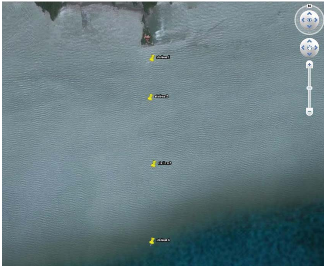
รูปที่ 7.9 จุดติดตั้งเครื่องดักตะกอน จุดที่ 1-4 ห่างจากชายฝั่งประมาณ 0.56, 0.95, 1.53 และ 2.25 กิโลเมตรตามลำดับ
