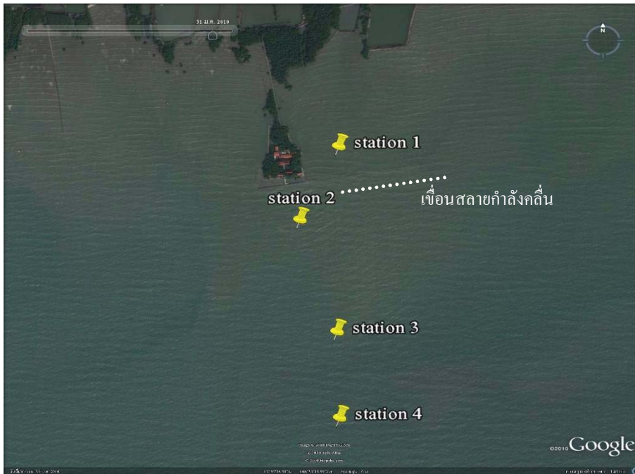
รูปที่ 7.6 จุดติดตั้งเครื่องดักตะกอน จุดที่ 1 - 4 ห่างจากชายฝั่งประมาณ 0.3, 0.5, 0.85 และ 1.1 กิโลเมตรตามลำดับ
