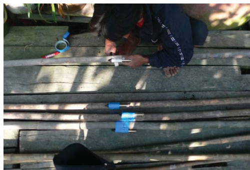
รูปที่ 3.2 เครื่องวัดระดับน้ำที่สามารถนำมาใช้วัดคลื่น ยี่ห้อ Solinst รุ่น 3001
