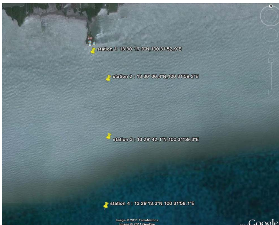
รูปที่ 7.7 จุดติดตั้งเครื่องวัดตะกอน จุดที่ 1, 2, 3, และ 4 ห่างจากชายฝั่งประมาณ 0.5 กิโลเมตร, 0.95 กิโลเมตร, 1.67 กิโลเมตร และ 2.5 กิโลเมตร ตามลำดับ
