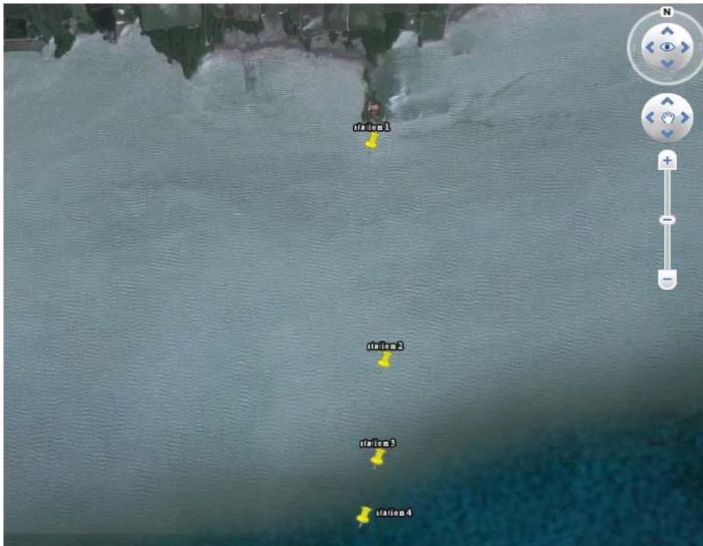
รูปที่ 7.10 จุดติดตั้งเครื่องดักตะกอน จุดที่ 1-4 ห่างจากชายฝั่งประมาณ 0.5, 1.5, 2.17 และ 2.4 กิโลเมตรตามลำดับ
