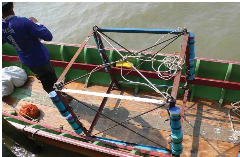
รูปที่ 7.3 รูปของเครื่องดักตะกอนที่ทำจากเหล็กฉากและท่อพีวีซี (แบบ 2 ระดับ)
