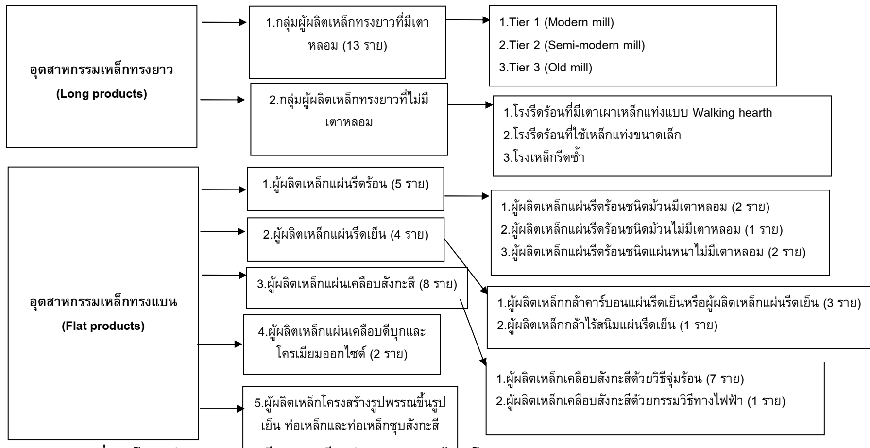
รูปที่ 5-5 โครงสร้างการผลิตเหล็กและเหล็กกล้าของประเทศไทย โดยแบ่งประเภทตามสายการผลิตและรูปร่าง [31]
