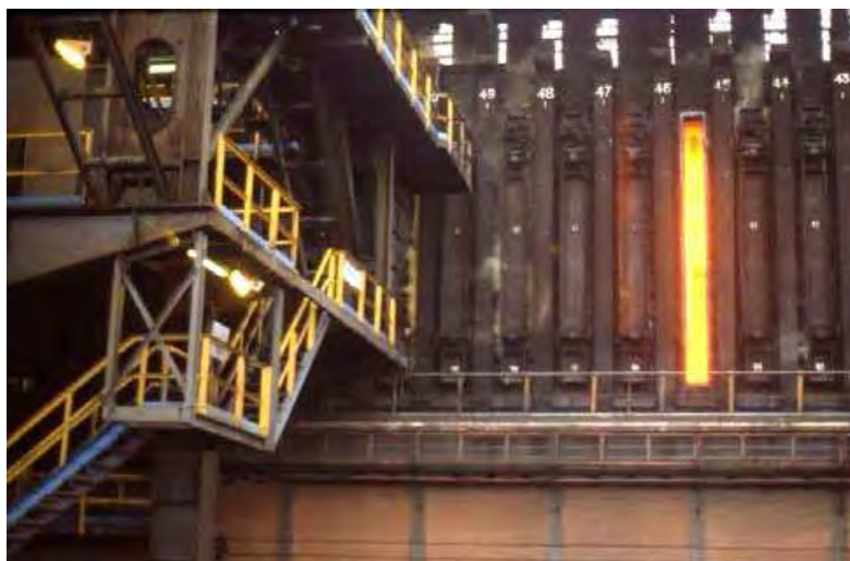
รูปที่ 2-9 ภาพ Coke ร้อนในเตาย่อยๆใน Coke oven [26]
