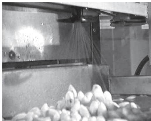
ภาพที่ 2 แสดงอุปกรณ์การรวบและสาวเส้นไหม
