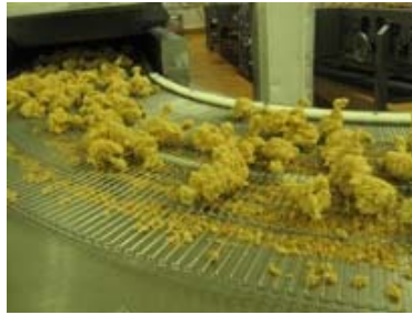
รูปที่ 4-31 กระบวนการทอดและเคลื่อนที่ด้วยสายพานลำเลียง
