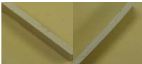
รูปที่ 12 ภาพตัดขวางของยางที่ใช้สารเติมแต่งไทเทเนียมไดออกไซด์ขนาดอนุภาคระดับนาโนเมตรและไมโครเมตรที่ผ่านการฉายแสงยูวี
