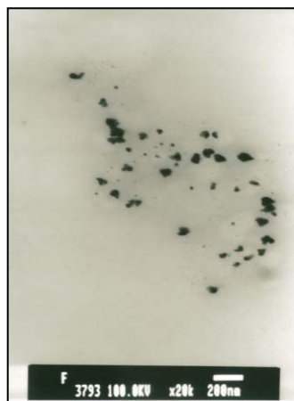
รูปที่ 1 ผลการวิเคราะห์ขนาดอนุภาคซิลเวอร์นาโนด้วยกล้องจุลทรรศน์อิเล็กตรอนแบบส่องผ่าน (TEM)
