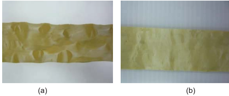
รูปที่ 3.8 ภาพถ่ายแสดงพอลิเมอร์ผสม NR-PLA (60 %NR) ที่ผ่านการผสมด้วยเครื่องอัดรีดแบบสกรูเดี่ยว : (a) ผ่านการอัดรีด 1 รอบ (b) ผ่านการอัดรีด 2 รอบ
