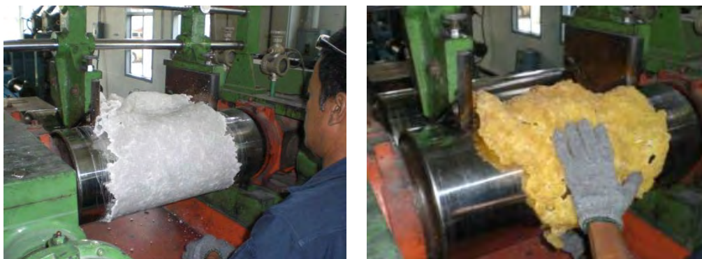
รูปที่ 10 การบดยางธรรมชาติและยางสังเคราะห์ให้เข้ากันด้วยเครื่องบดผสมยางแบบสองลูกกลิ้ง
