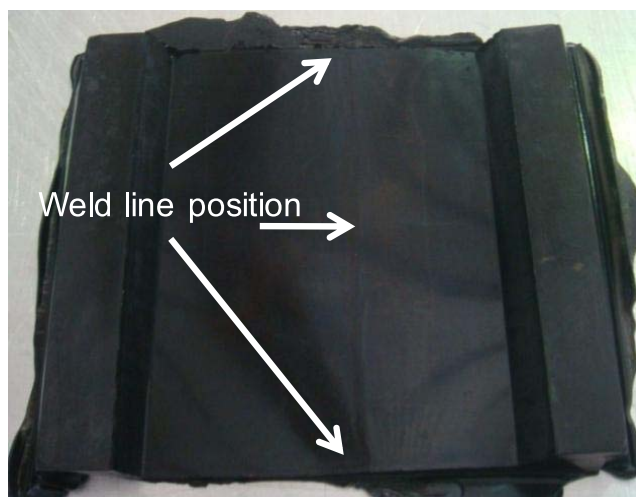
รูปที่ 15 ชิ้นงานยางที่มีรอยประสานเมื่อผ่านกระบวนการอัดขึ้นรูป
