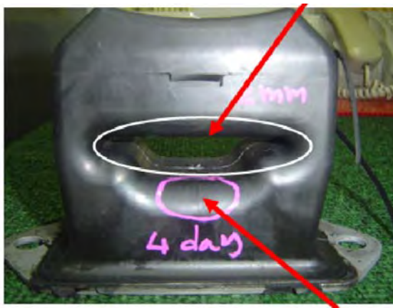
รูปที่ 1 ตำแหน่งการเกิดรอยประสาน ในกระบวนการอัดขึ้นรูปผลิตภัณฑ์ยาง
