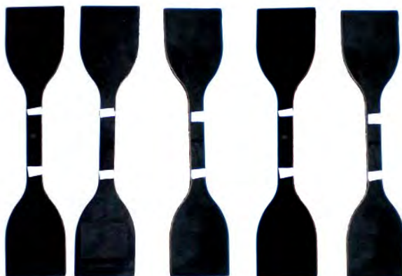
รูปที่ 16 ชิ้นงานรูปตั้มเบลเพื่อทดสอบสมบัติการต้านทานต่อแรงดึง
