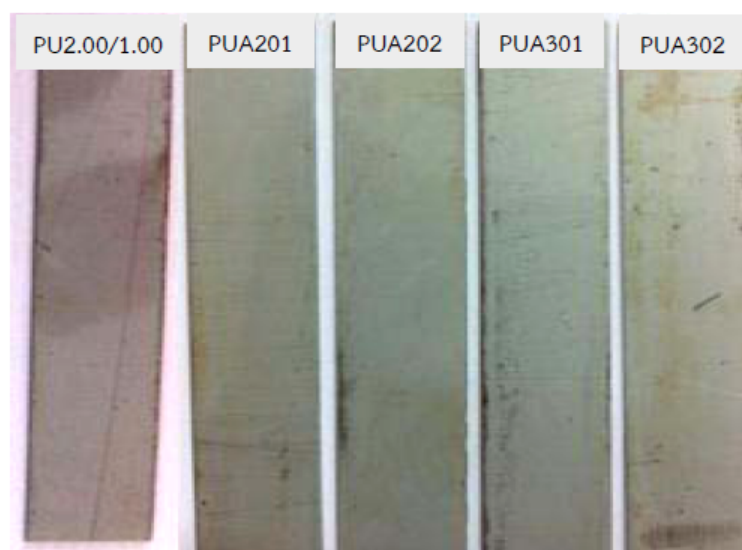
รูปที่ 4 ลักษณะปรากฏของผิวเคลือบพอลิยูรีเทนที่ end capping ปลายสายโซ่ด้วยสารประกอบอะคริเลต
