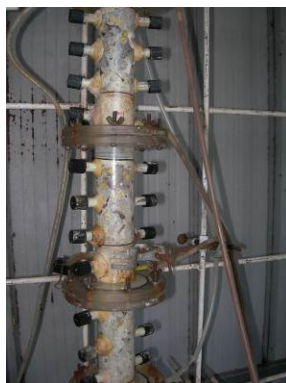
ก. Elemental sulfur ตกค้างบนตัวกลาง
