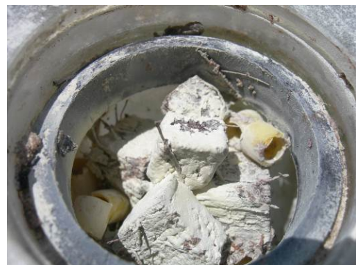
ข. Elemental sulfur ปกคลุมรอบตัวกลาง
