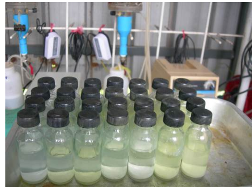
ง. การดูดซึม H_2S ด้วยแคดเมียมซัลไฟด์
