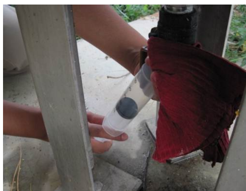
จ. การเก็บก๊าซชีวภาพเพื่อวิเคราะห์ H_2S
