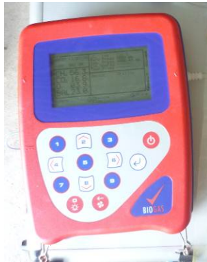
ภาพที่ 3.7 เครื่องวัดองค์ประกอบก๊าซชีวภาพ
