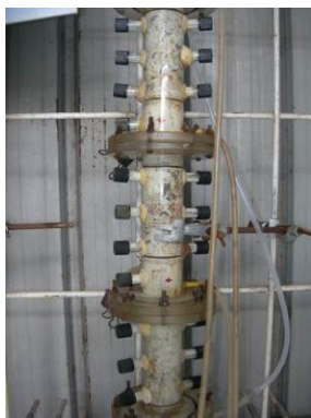
ภาพที่ 4.31 การสะสม elemental sulfur ระหว่างชั้นตัวกลางในระบบกรองชีวภาพ
