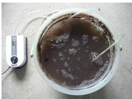
ค. การตรึงเชื้อจุลินทรีย์บนเปลือกมะพร้าว
