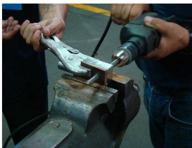
รูปที่ 39 ขั้นตอนการเจาะรูเพื่อยึดฉนวนกับตัวจับยึดชิ้นงานในส่วนที่เป็นทองแดง
