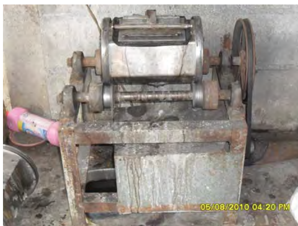
ภาพประกอบที่ 16 เครื่องขัดเงาแบบน้ำหรือเครื่องร่อนแบบไฟฟ้า
