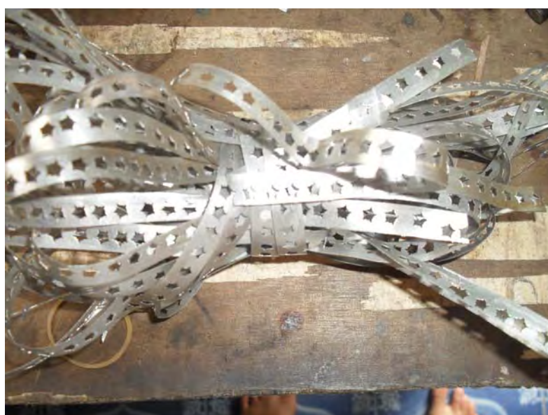
ภาพประกอบที่ 20 จากเงินแท่งผ่านการรีดด้วยเครื่องรีด เหลือจากการขึ้นรูปต่างๆ (สามารถนำกลับไปหลอมใหม่)
