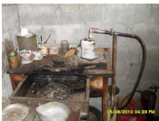
ภาพประกอบที่ 11 เครื่องหลอมที่ป้อนแบบใช้แก๊สออกซิเจน
