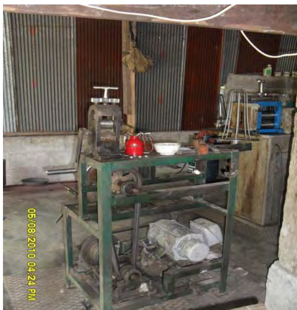
ภาพประกอบที่ 14 เครื่องดึงลวดโดยใช้มอเตอร์ไฟฟ้า
