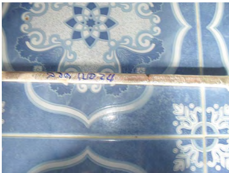
ภาพประกอบที่ 21 เงินเม็ดที่หลังจากผ่านการหลอมหลังแกะออกจากรางเทโลหะ
